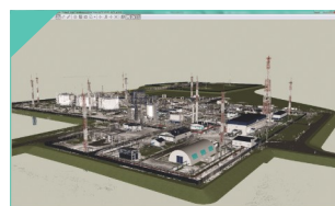
Работа с облаком точек лазерного сканирования
